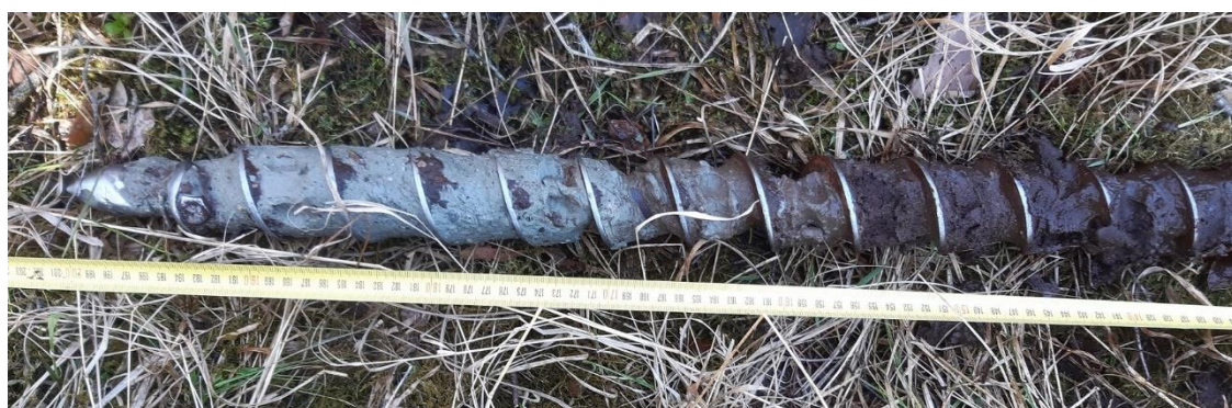
Foto 5.4. Turbalasundi lamamis olev sinakashall liivsavimoreen on vähese peene purdosa. PA-7, int 1,3 – 1,9 m.
