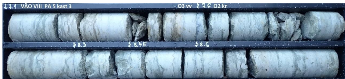
Foto 5.9. Uhaku lademe Kõrgekalda kihistu mergli vahekihtidega lubjakivi. Sügavusel 7,6 m markeerib katkestuspind Viivikonna ja Kõrgekalda kihistute vahelist piiri. PA-5, int 7,1 – 9,0 m.
