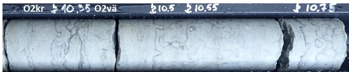
Foto 5.10. Katkestuspindadega ~0,5 m paksune lubjakivikompleks, kus ülemine kahekordne katkestuspind on Kõrgekalda ja Vão kihistu piiriks.
