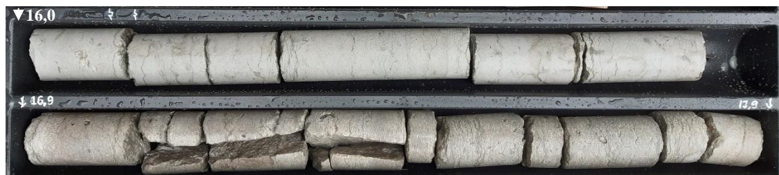
Foto 5.11. Vão kihistu Kostivere (int 16,0 – 16,9 m) ja Pae (int 16,9 – 17,9 m) kihistiku lubjakivi puuraugus PA-2.
