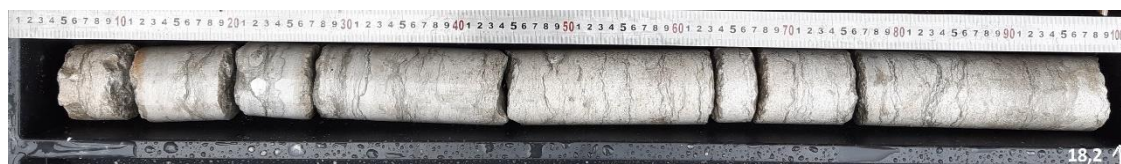
Foto 5.12. Vão kihistu Rebala kihistiku lubjakivis on mergli kelmeid ja vahekihte tihedamalt. PA-6, int 17,2 - 18,2 m.
