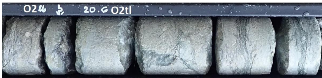
Foto 5.16. Toila kihistu ülemises pooles lasub mergli vahekihtidega peeneteralise glaukoniidiga lubjakivi. PA-5, int 20,5 – 20,9 m.
