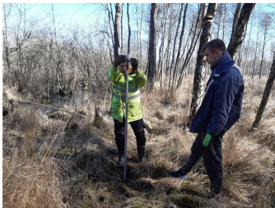
Foto 4.2. Puuraugu PA-7 rajamine käsi- puuriga (foto T. Tuuling, 13.04.2020, N 59°25'17" ja E 24°53'3").
