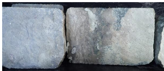
Foto 5.15. Loobu-Toila kihistu vahelist piiri markerib tugeva limoniit-fosfaatse impregnatsiooniga katkestuspind. PA-3, int 21,8 - 22,0 m.
