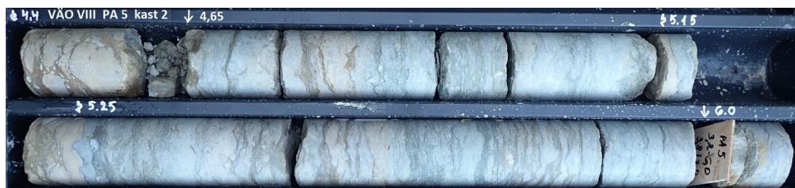
Foto 5.8. Viivikonna kihistu alumises osas (sügavuselt 5,25 m) on kukersiitsete lubjakivide sisaldus oluliselt väiksem. PA-5, int 4,4 - 6,1.
